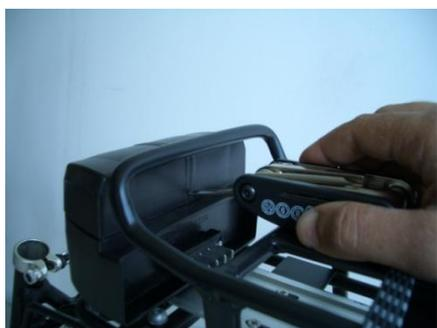
Rimuovere la vite posteriore di fissaggio del coperchio Controller utilizzando le chiavi in dotazione.
