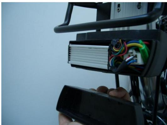
Riposizionare il Controller nel suo alloggio e richiudere il coperchio. Fissarlo con le apposite viti.
