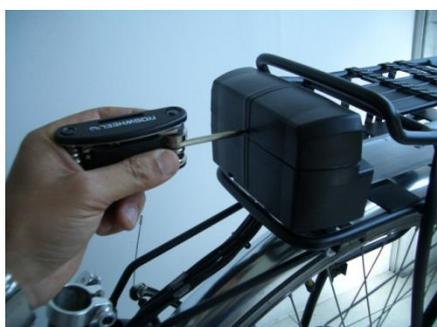
Rimuovere anche la vite anteriore di fissaggio del coperchio.
