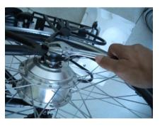
Rimuovere la catena dalle corone e allentare i bulloni di fissaggio della ruota.
