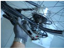
Rimuovere la vite di fissaggio del selezionatore marcia.
