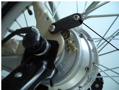
Rimuovere la vite di fissaggio del selezionatore marcia. Sganciare il selezionatore spostandolo all'esterno del telaio.
