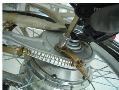
Rimuovere la vite di fissaggio del freno a tamburo posteriore e rimuovere il fissaggio del cavo del freno.
