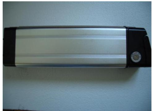
Ruotare la Batteria fino a vedere lo sportellino del Fusibile (FUSE).
