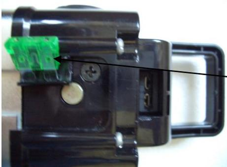
Rimuovere e sostituire il FUSIBILE utilizzandone uno di uguale taratura (A).
