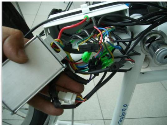
1. Rimuovere il Controller dal suo alloggio e scollegare i cablaggi facendo MOLTA ATTENZIONE a non corto-circuitare i cavi di colore "rosso" e "nero".
