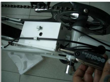
Rimuovere la vite di fissaggio del coperchio Controller utilizzando le chiavi in dotazione.
