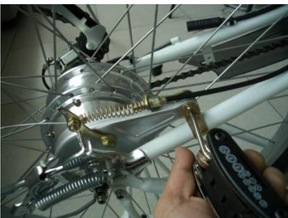
Rimuovere la vite di fissaggio del selezionatore marcia e anche quella che ferma il freno a tamburo posizionata sul lato opposto.
