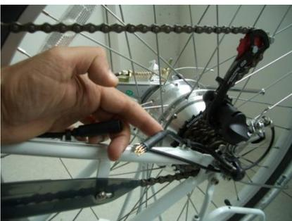
Rimuovere lo spinotto di collegamento del motore sulla ruota.
