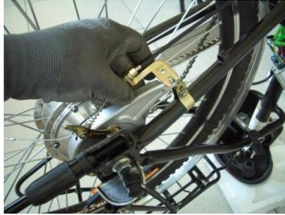
Rimuovere la vite di fissaggio del freno a tamburo posteriore e rimuovere il fissaggio del cavo del freno.
