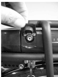
Il foro di innesto dello spinotto di uscita dell'adattatore AC/DC carica-batteria, si trova sul lato delle chiavi, sollevando il coperchio di gomma.
