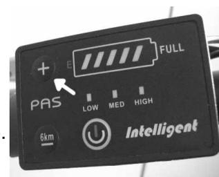
Una spia posta nella parte superiore della batteria permette di controllare a vista lo stato del fanale. In ogni caso quando il fanale è acceso, le spie luminose sul pannello di controllo diventano più fioche, e questo vi indica lo stato del fanale posteriore senza dover guardare la spia sulla batteria.
