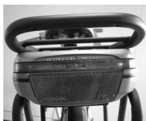
il fanale POSTERIORE a luce LED è integrato nella batteria della bicicletta. Esso si accende e si spegne premendo per almeno 2 sec. il pulsante (+) posto sul PANNELLO di CONTROLLO sul manubrio. Una Successiva pressione di almeno 2 sec. lo spegne.
