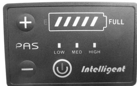
**2 - Pulsante (+)** : ad ogni breve pressione AUMENTA in sequenza la VELOCITA' dell'azione del MOTORE tra: LOW = minima ; MED = media ; HIGH = massima. la velocità prescelta viene indicata dalla sottostante SPIA LUMINOSA accesa. Una pressione "lunga" accende / spegne il FANALE POSTERIORE.
