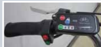
Centralina di controllo
